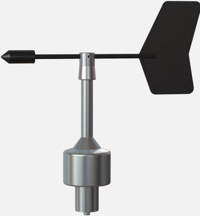
WxD-130은 공기중의 풍향을 측정하는 장치로서, 8 bit의 그레이코드를 사용하여 높은 분해능 및 뛰어난 정확도를 보이며, 풍향계의 몸체는 알루미늄 아노다이징 표면 처리를 통해 높은 내구성을 가집니다.
