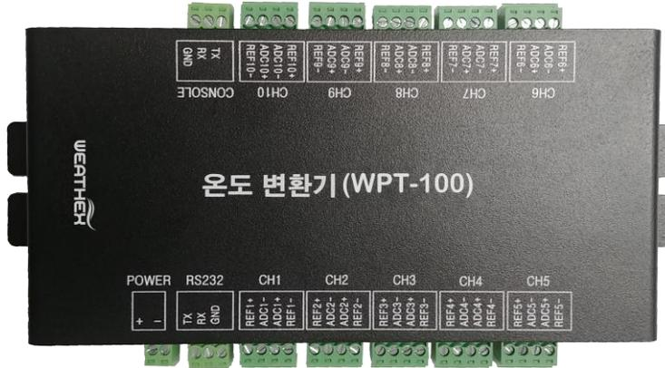
4선식의 RTD 센서를 10개 수용할 수 있으며, 채널 별로 캘리브레이션을 수행하여 보다 정확한 온도값을 측정할 수 있습니다. 또한 DIN 타입과 JIS 타입 별로 설정할 수 있어 높은 호환성을 자랑하며 범용적인 사용 및 고정밀이 필요한 기상관측에 사용이 가능합니다.
