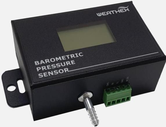
WxB-101L은 내부 실리콘 용량성을 사용하여 기압을 측정하는 방식이며, 이는 압력 측정의 장기적인 안정성 및 고정밀도를 보장합니다. 측정된 압력 데이터는 RS-232 인터페이스 및 프로토콜을 통해서 LCD 창에 표시됩니다. 범용적인 사용 및 고정밀이 필요한 기상관측에 사용이 가능합니다.
