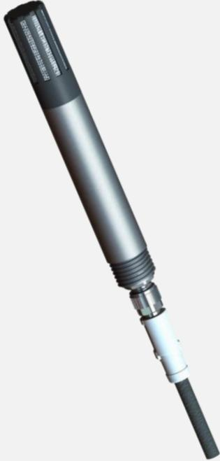
WxHT-120은 공기중의 온도 및 상대습도를 측정하는 장치로, 감지부의 테프론 필터 장착을 통해 먼지 등에 높은 내구성을 보이며, Capacitive 습도 센서를 통해 빠른 응답 속도 및 높은 안정도를 가지고 있습니다. 범용적인 사용 및 고정밀이 필요한 기상관측에 사용이 가능합니다.
